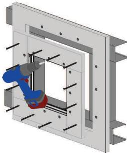
Remover la puerta de la trampa y presionar el marco exterior desde la parte anterior contra los perfiles en C. Durante el montaje, verificar que los cierres de click queden en la parte superior. Fijar el marco exterior a los perfiles en C con tornillos autoperforantes a una distancia máxima de 13 cm.
