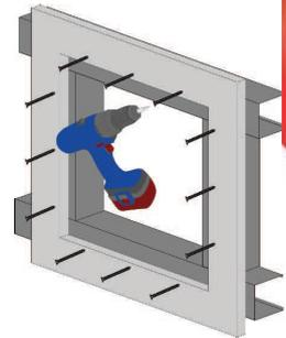
Colocar los perfiles en C alrededor del corte realizado sobre el trasdosado, de manera que queden en relieve hacia el interno de la apertura, de aproximadamente 2,5 cm.
