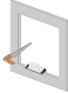
Cortar la apertura de la pared (con serrucho o sierra de arco).
