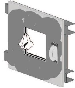
Después de enmasillar, limpiar los dos marcos (interior y exterior) si quedan residuos. Es muy importante limpiar siempre los marcos durante el montaje para evitar problemas de funcionalidad de la trampa. Una vez la masilla esté completamente seca, rectificar eventuales desniveles.
