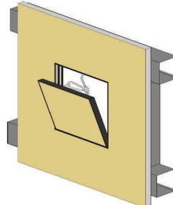
Insertar la puerta con los pernos hacia abajo, encajándolos en las perforaciones del marco exterior. Enganchar la cadena de seguridad y cerrar la trampa. La cadena de seguridad debe quedar cerrada, después de utilizar la trampa.
