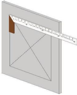
Medir el marco exterior y con ayuda de una falsa escuadra dibujar el perfil de la apertura sobre el trasdosado sobre el cual la trampa será instalada
