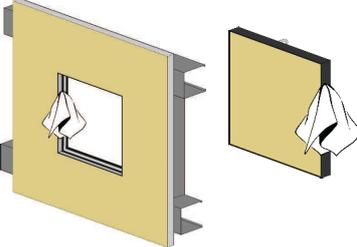
Cubrir atentamente los cierres de click antes de pintar y limpiar eventuales residuos de pintura sobre los dos marcos (interior y exterior). Tener cuidado de no dañar la junta: esta debe quedar intacta después de la instalación.
